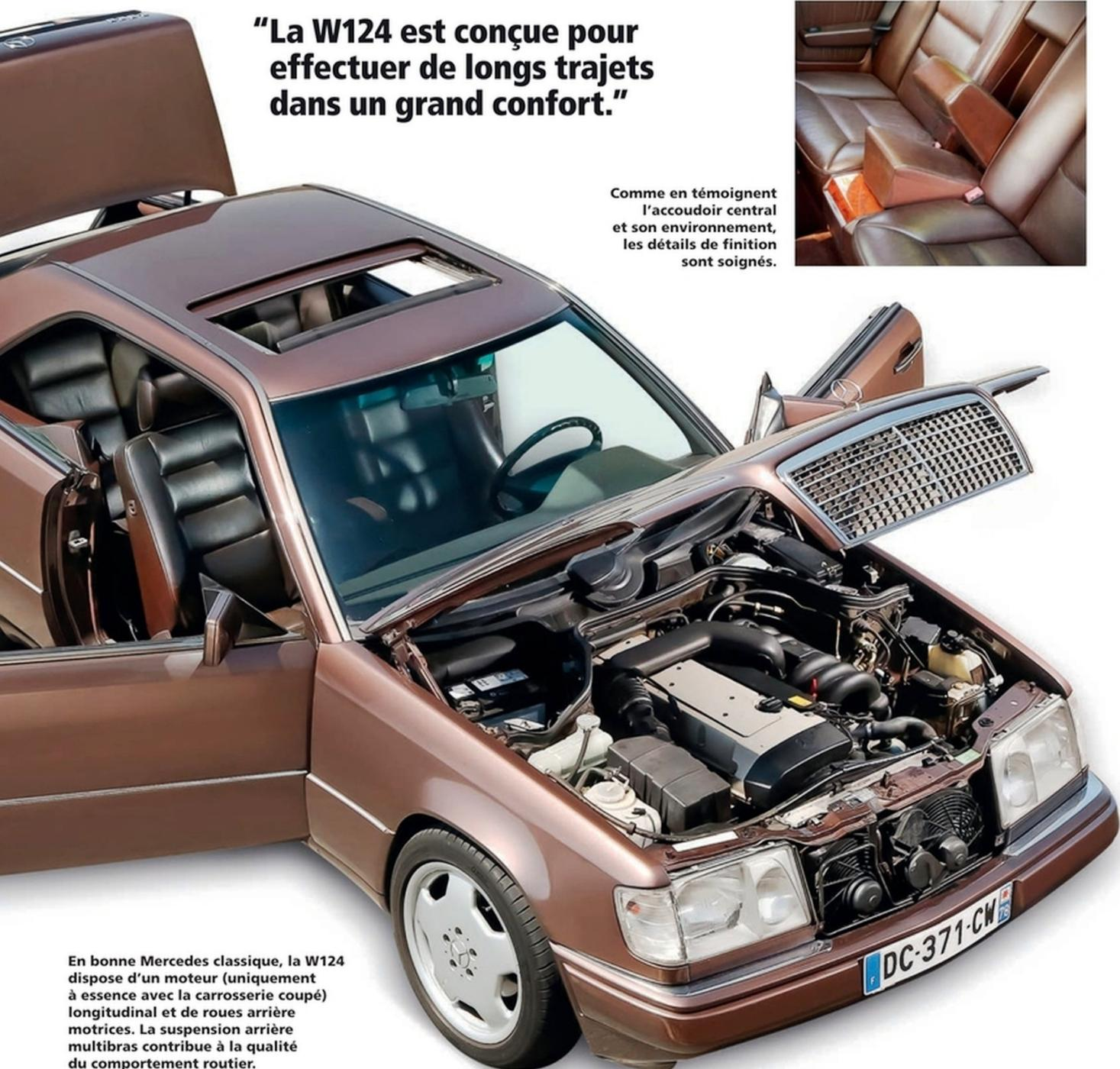
En bonne Mercedes classique, la W124 dispose d'un moteur (uniquement à essence avec la carrosserie coupé) longitudinal et de roues arrière motrices. La suspension arrière multibras contribue à la qualité du comportement routier.
