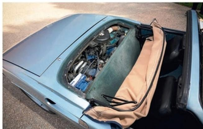
Le capot moteur partiellement grillagé d'origine fait place à un élément en polyester et à une plage arrière revêtue de moquette. Au moins, le système d'armature façon “tente de camping” de la capote ne risque pas de tomber en panne... L'accessibilité mécanique d'une auto à moteur central arrière n'est jamais bien pratique. En revanche, cette architecture garantit une tenue de route phénoménale.
