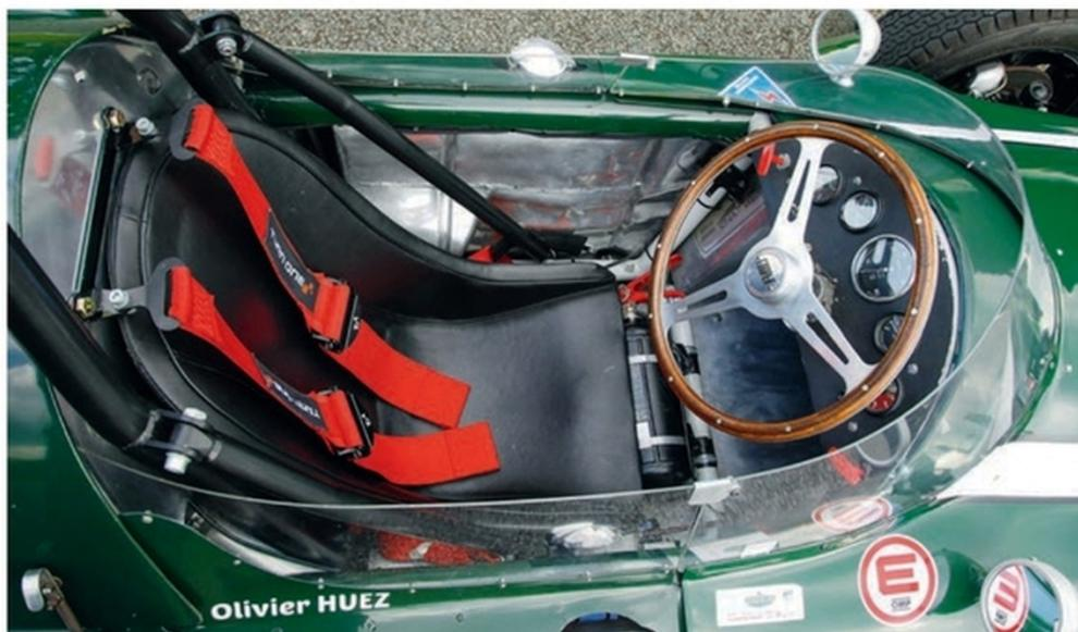
Le pilote est presque allongé entre les tubes du châssis et le réservoir d'essence.
