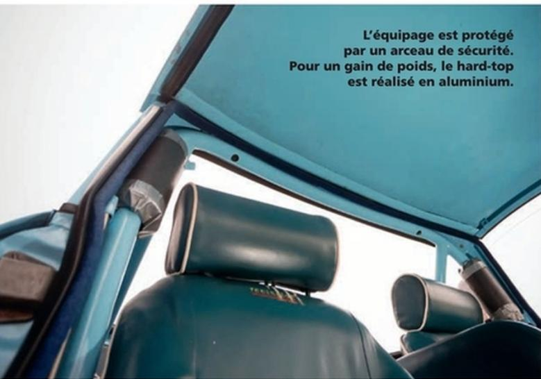
L'équipage est protégé par un arceau de sécurité. Pour un gain de poids, le hard-top est réalisé en aluminium.
