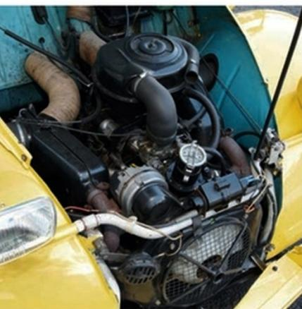
Le bicylindre 435 cm<sup>3</sup> d'origine a fait place à un 602 cm<sup>3</sup> plus puissant.
