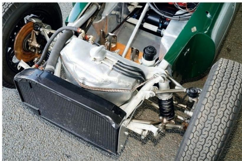
**Direction directe, réservoir de liquide de frein derrière le radiateur, et palonnier positionné juste en avant de l'axe des roues.**
