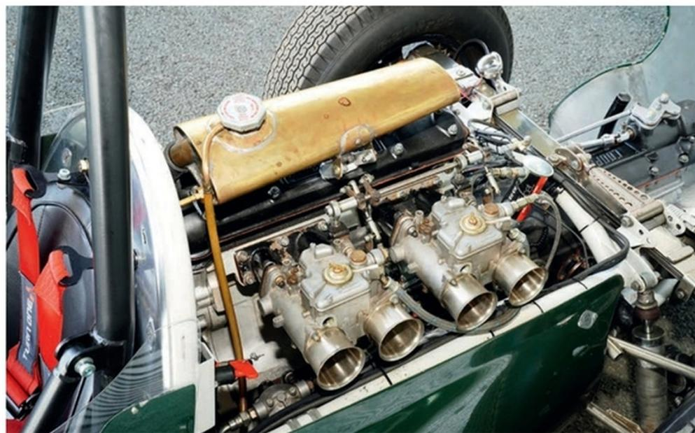
Cela aurait pu être un 8-cylindres en V, finalement le FPF restera un 4-cylindres en ligne comme l'étaient les motopompes dont il est issu...
